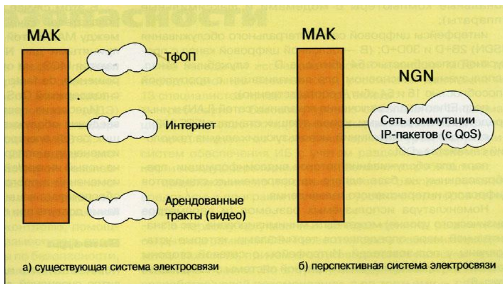
Сурет 2.11 - Мультисервистік абоненттік концентраторларды қосудың екі нұсқасы
